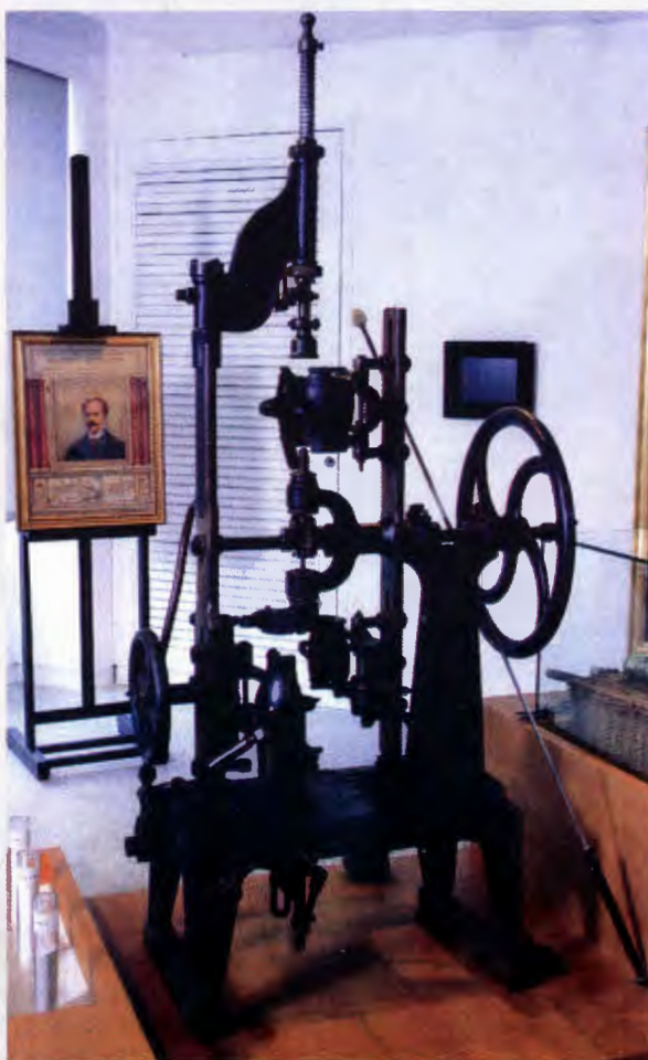
En dépôt au Musée des arts du cognac à Cognac (Charente), cette machine à fabriquer les bouteilles par moulage de Claude Boucher, modèle 1903, appartient à la Collection du Musée des arts et métiers au Conservatoire national des arts et métiers (Cnam) à Paris.
