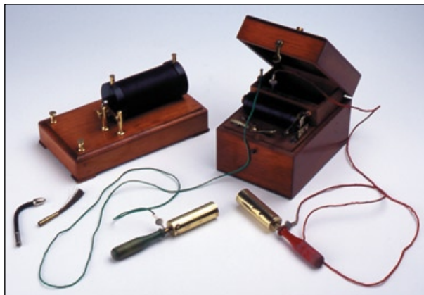
Bobine de Ruhmkorff (avec appareil de Gaiffe) Catalogue n° 58
