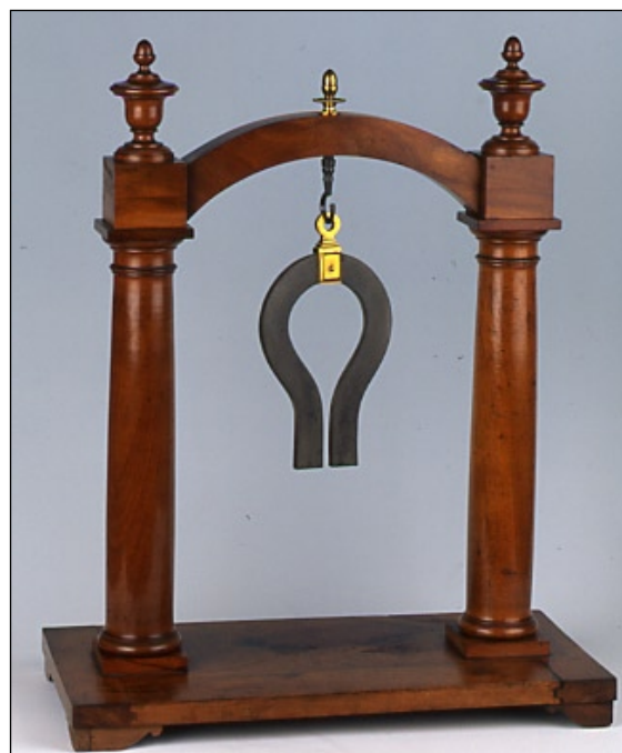
Faisceau magnétique Catalogue n° 42
