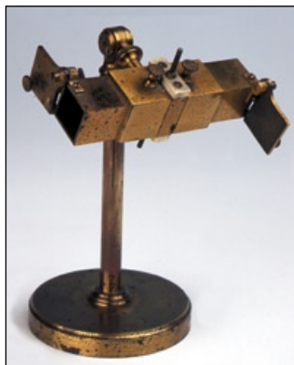
Pile thermo-électrique de Melloni Catalogue n° 26
