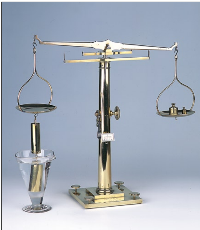
Balance hydrostatique Catalogue n° 8
