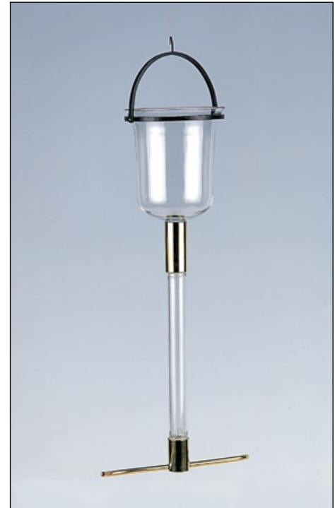
Tourniquet hydraulique Catalogue n° 7
